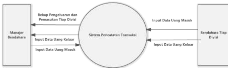
Gambar 6 DFD Level 0 Sistem Pencatatan Transaksi
